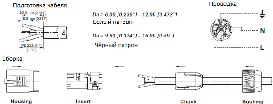
Рисунок 10 – Соединение разъёма входа питающего напряжения с кабелем
