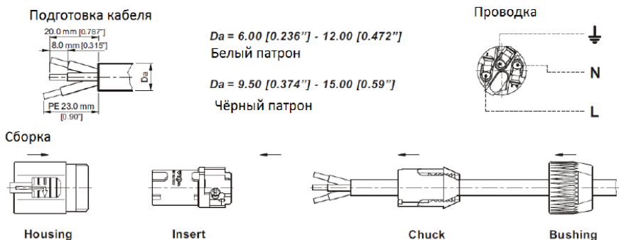
Рисунок 9 – Соединение разъёма входа питающего напряжения с кабелем
