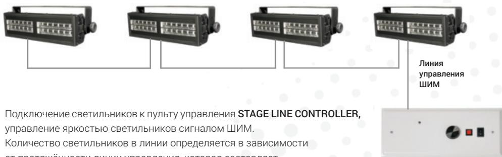
Подключение светильников к пульту управления **STAGE LINE CONTROLLER**, управление яркостью светильников сигналом ШИМ. Количество светильников в линии определяется в зависимости от протяжённости линии управления, которая составляет не более 30 м (от блока управления до последнего светильника).
