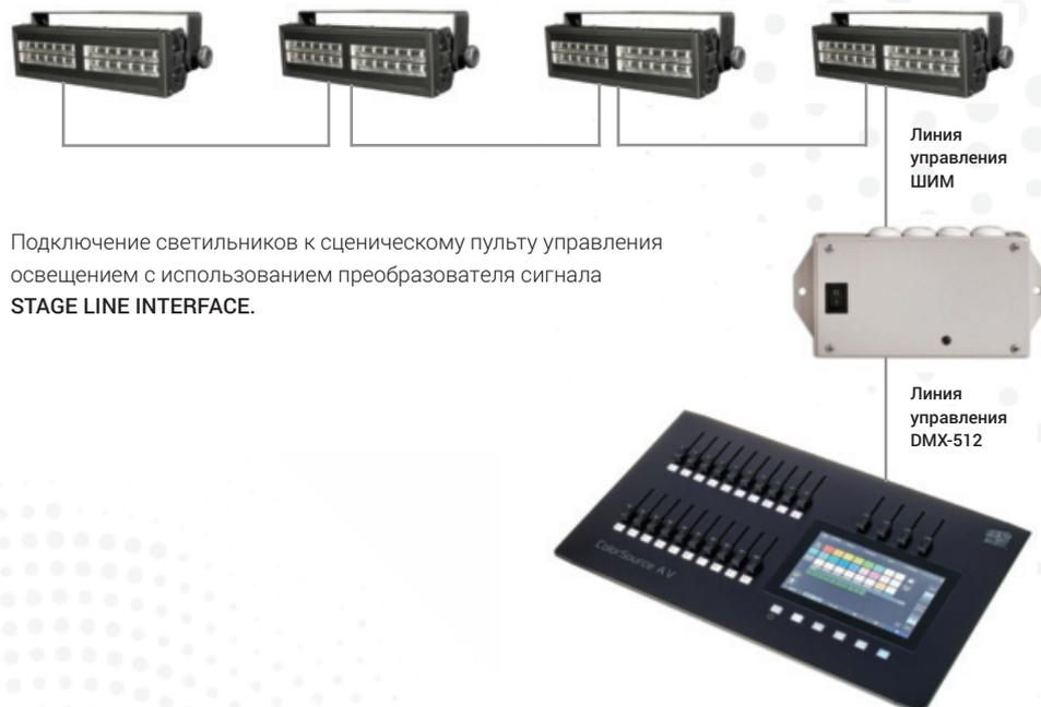
Подключение светильников к сценическому пульту управления освещением с использованием преобразователя сигнала **STAGE LINE INTERFACE**.
