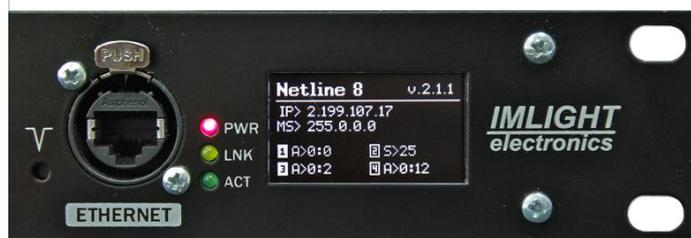
При наличии подключения по сети Ethernet светодиод LINK мигает в моменты передачи и приема информации по сети. Мигающий светодиод ACTIVE сигнализирует, что процессор устройства находится в рабочем состоянии.
