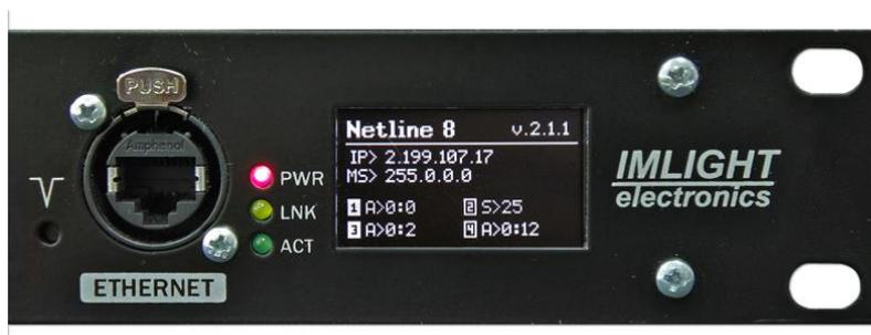
Если вам нужно вернуть все настройки блока к заводским параметрам, для этих целей в блоке предусмотрена кнопка (обозначена галочкой), которая находится слева от разъема RJ-45. Кнопка утоплена за переднюю панель. Аккуратно острым предметом нажмите на кнопку и удерживайте ее в течении 8-10 сек, затем отпустите (кнопка работает на отпускание).
