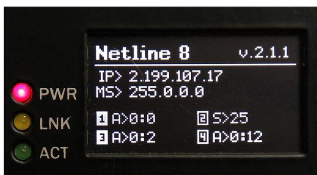
1. В верхней строке слева указано название блока (заводская настройка). При необходимости вместо заводского названия можно присвоить свое название прибору (макс. 12 символов и **только на английском языке**). Справа в верхней строке отображается версия программного обеспечения.
